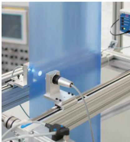
玻璃, Plexiglas®, PET 和 PVC 薄膜以及纸张的在线颜色梯度的测量
