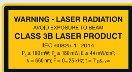
Fig. 10 Laser label and laser warning sign LLT30xx-430, LLT30xx-600
