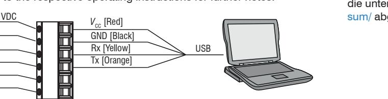
! Verwenden Sie nicht das grüne und das braune Kabel vom USB-Adapter. Diese können gegebenenfalls abgeschnitten werden.
