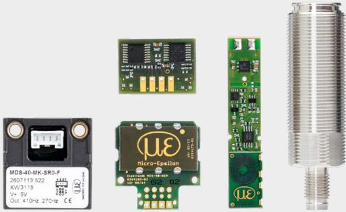
磁感应传感器有不同的型号。从坚固耐用的不锈钢型号到紧凑的PCB型号，该系列产品能为各个应用场景提供合适的型号。磁铁决定了测量范围，磁体越大，测量范围就越大（最大可达55毫米）。
